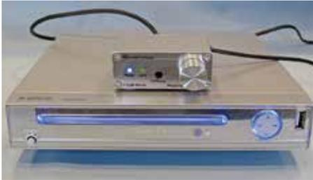
写真のようにDVDプレーヤーにヘッドホンアンプを接続、DVDプレーヤーにCDを入れて、再生。
